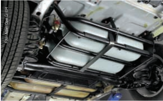
Unterflurig eingebaute Erdgastanks.
